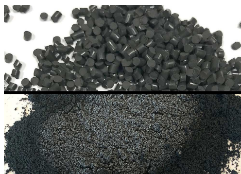
Schnelle Zerkleinerung von schwarzem Fluorcarbon-Kautschuk (FKM) durch Versprödung der Probe bei - 100 °C in 125 ml Mahlbechern.
