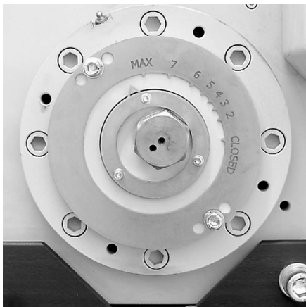
Skala für stufenlose Spaltweiteneinstellung
