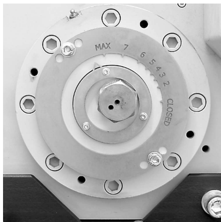
Échelle pour le réglage en continu de la largeur de fente
