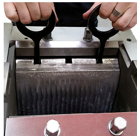
Les mâchoires de concassage et les plaques d'usure peuvent être remplacées
