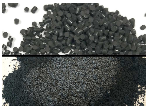
Molienda rápida de caucho negro de flurocarbono (FKM) mediante la fragilización de la muestra en dos recipientes de 125 ml a -100 °C.
