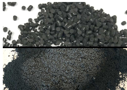
Macinazione rapida di Elastomeri fluorurati (FKM) mediante infragilimento del campione in due giare da 125 ml a -100 °C.
