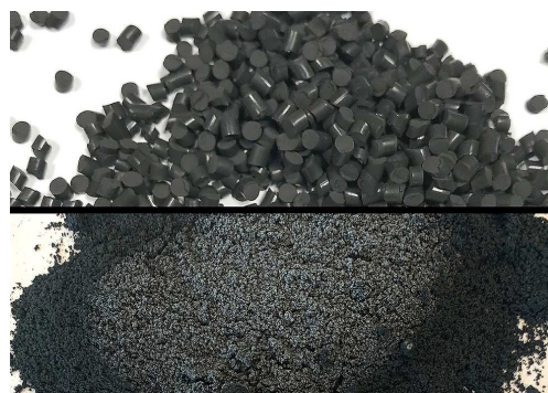
黒色の炭化水素ゴム（FKM）を125ml×2 粉碎ジャーに投入し、-100℃の環境下で高速粉碎する。
