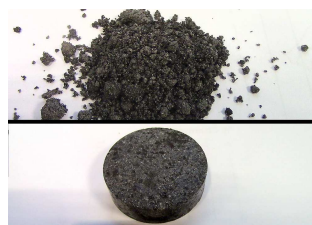
炉渣 40 克 粒径 0.25 毫米 压制工具 40 毫米
