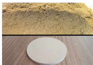
木材 4 克 粒度 0.25 毫米 压制工具 32 毫米
