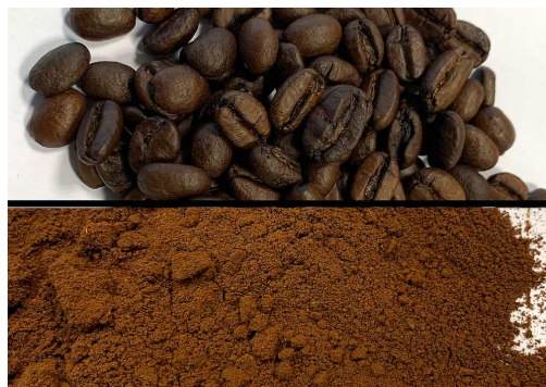
Измельчение кофейных зерен при низких температурах для анализа натуральных веществ.
