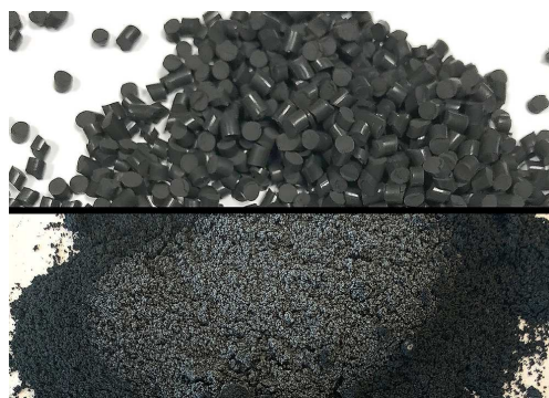
Măcinarea rapidă a cauciului negru Fluorocarbon (FKM) prin fragilizare în două incinte de 125 ml la -100 °C.
