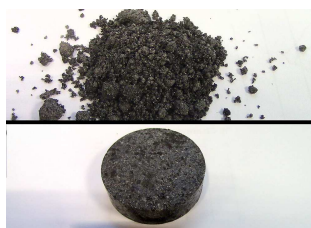
Struska 40 g Velikost částic 0.25 mm Lisovací nástroj 40 mm 20 s 20 tun
