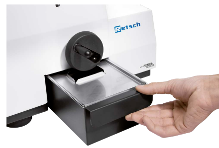
Veľká zberná nádoba (3 l) s voliteľným vekom
