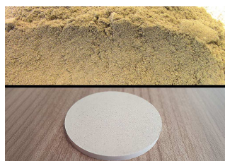
Drevo 4 g Veľkosť častíc 0,25 mm Lisovací nástroj 32 mm 20 s pri 10/20/30 tonách
