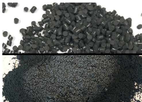
Rýchle mletie čiernej fluorkarbónovej gúmy (FKM) krehnutím vzorky v dvoch 125 ml nádobách pri -100 °C.
