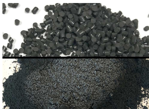
Moagem rápida de borracha de fluorecarbono preto (FKM) fragilizando a amostra em dois frascos de 125 ml a -100 °C.
