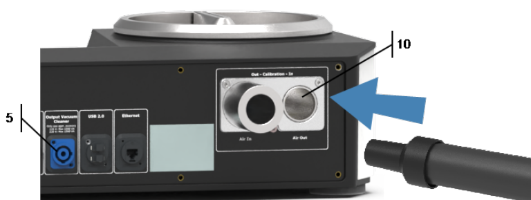
Fig. 7: Collegare l'aspirapolvere industriale
